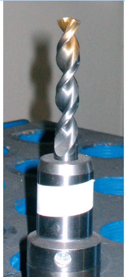
6 Lläuft wie geschmiert: der neue MMS-gerechte Bohrer verkürzte bei gleicher Prozesssicherheit die Bohrbearbeitung um 70 Prozent
