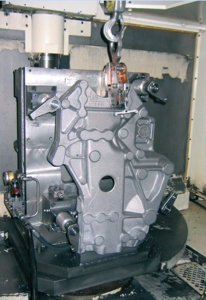
3 Saubere Sache: Durch den minimalen Eintrag an Schmierstoff bleibt der Innenraum der Maschine trocken und kann daher einfach gereinigt werden
